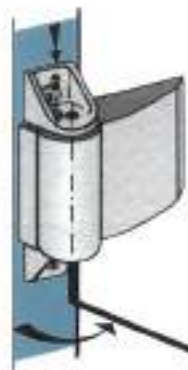
Tendre et bloquer le ressort. Vérifier la fermeture de la porte, ajuster si nécessaire.
